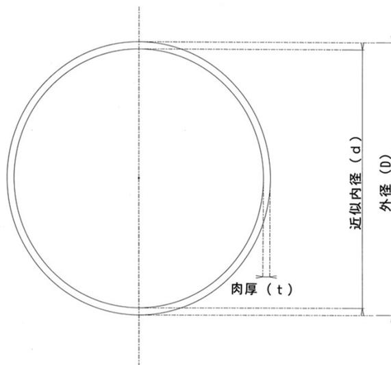
SUパイプは主に、壁の換気口取付などの埋込口などに使用されることが多く、またケーブルやコード・ベルトなどの保護材として使用される方など用途は様々です。VU管・VP管より薄肉で重量も軽いのが特徴です。
